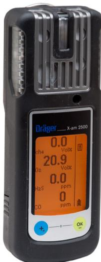
Equipamento Dräger para 4 gases
