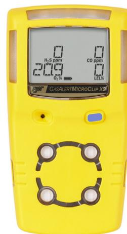
Equipamento Honeywell BW para 4 gases
