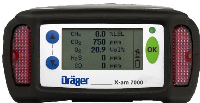
Equipamento Dräger para 5 gases
